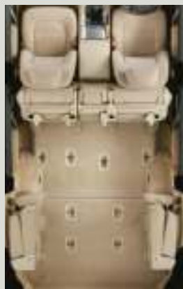
セカンドシートタンブル+サードシートスペースアップ状態
